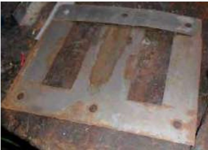
Figura 3. Núcleo cerrado en forma de I
