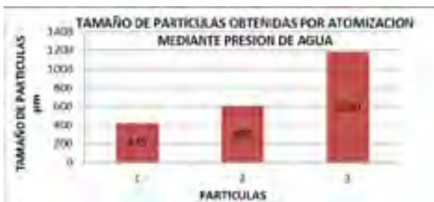
Figura 3.1. Tamaño de partículas por atomización mediante presión de agua
