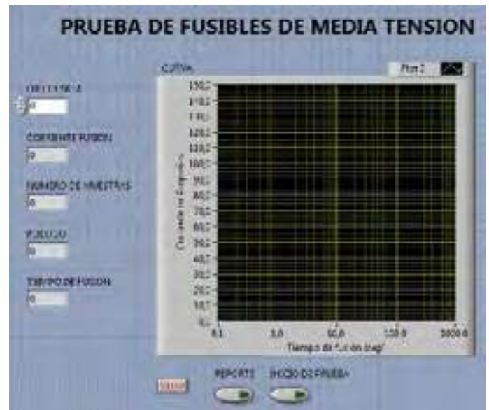
Figura 9. HMI para la prueba de fusibles de media tensión
