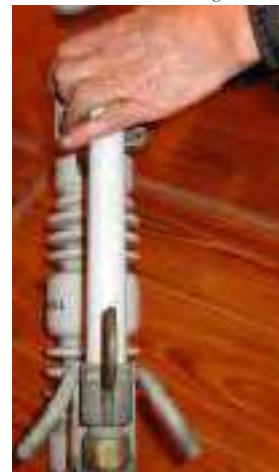
Figura 17. Portafusible junto al seccionador
