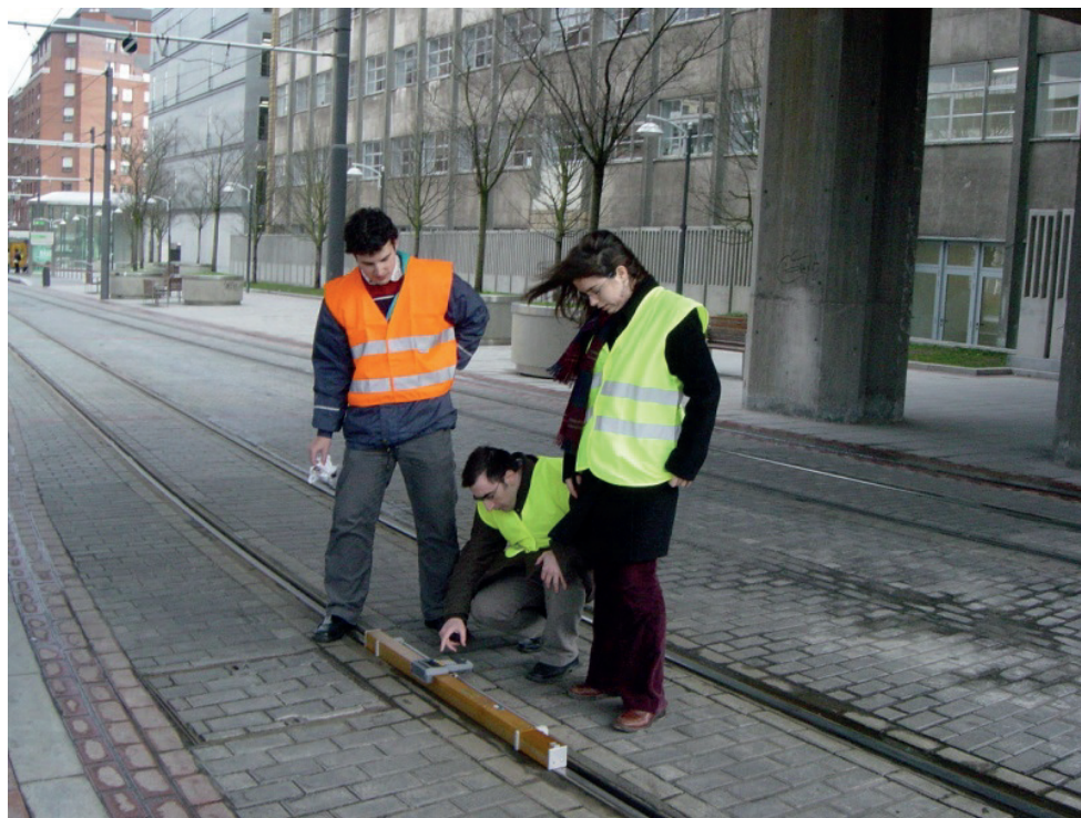
Figura 5. Sistema de medida de corrugación utilizado actualmente en la UPV/EHU de Bilbao.
