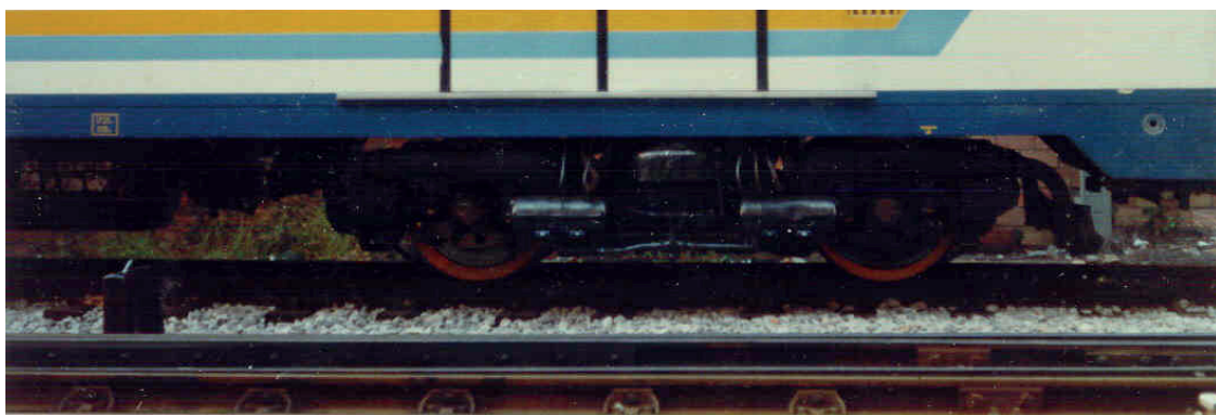
Figura 12. Unidad con ruedas dotadas de aros para suprimir el squeal.
