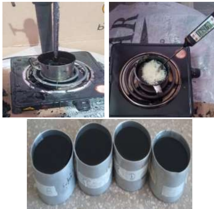
Figura 1. Elaboración de los ligantes asfálticos modificados
