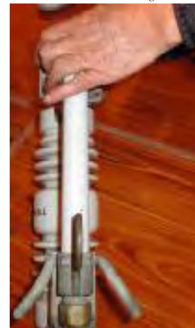
Figura 17. Portafusible junto al seccionador
