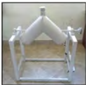
Figura 2.3. Mezclador de polvos en V. Fuente: Los investigadores
