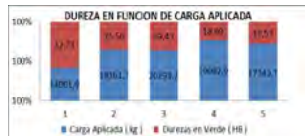
Figura 3.4. Dureza en función de carga aplicada
