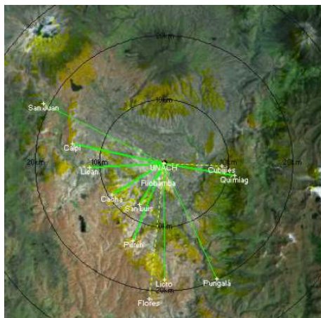
Figura 7. Enlaces de Microonda desde la UNACH a zonas agrícolas de parroquias de Riobamba.
