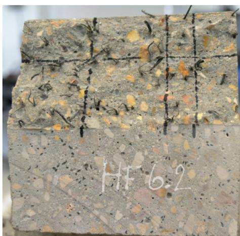
El número teórico de fibras se calcula según se indica en la ecuación (2) , donde  $A_c$  es la superficie de fractura,  $V_f$  es la relación entre el volumen de fibras en la probeta y el volumen de la probeta y  $A_f$  es el área de la sección transversal de una fibra.
